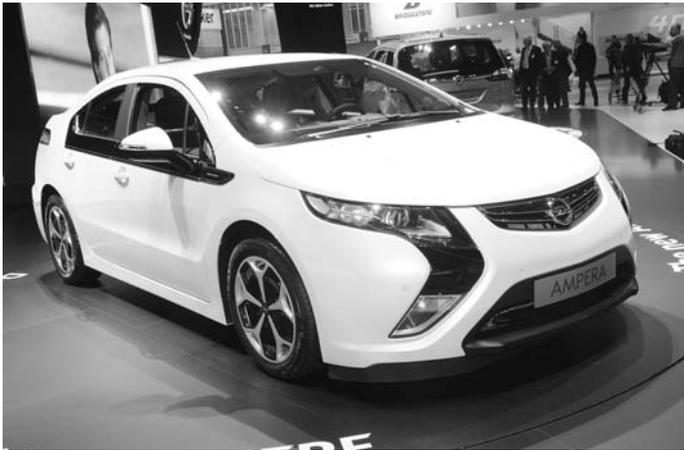
rator fürs Nachladen während der Fahrt an und erweitert somit die Reichweite auf bis zu 500 Kilometer. Der Ottomotor hat keine mechanische Verbindung zu den Rädern – der Antrieb erfolgt also immer rein elektrisch.
