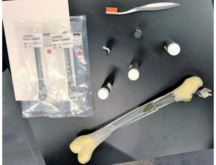
**Abb. 4:** Das in verschiedene Produkte eingearbeitete Silberadditiv sorgt für antimikrobielle Beschichtung.
